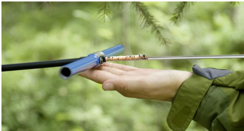
Sl. 3. Uzorkovanje Preslerovim svrdlom
